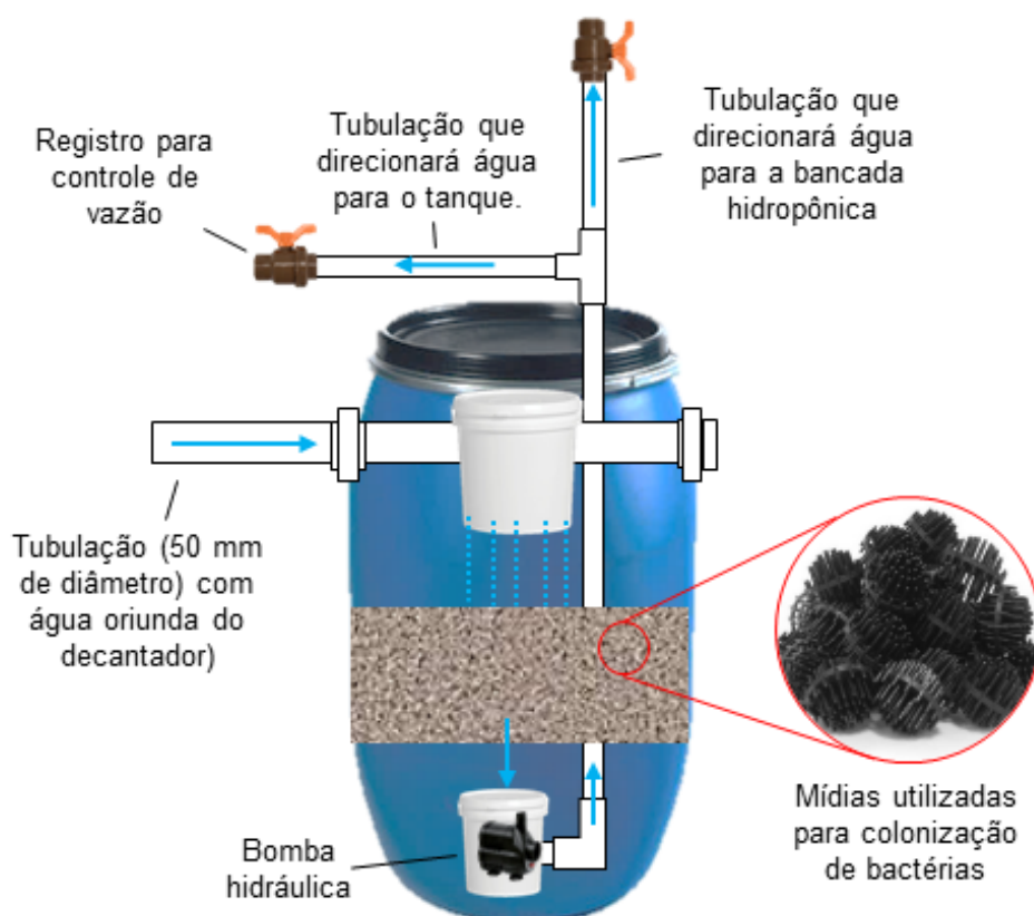
Figura 21 - Ilustração interna e externa do biofiltro utilizado no sistema aquapônico. Onde a seta azul indica o sentido do fluxo da água.
