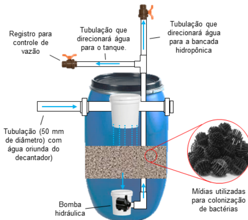
Figura 27 - Esquema ilustrativo sobre os detalhes internos e externos do biofiltro
